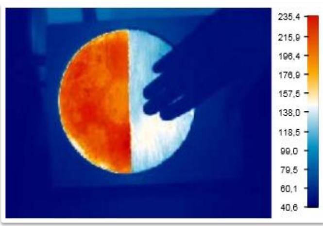
Теплоизолятор позволяет прикосновение к нагревательному элементу как минимум до 10 сек. без вреда для здоровья.
