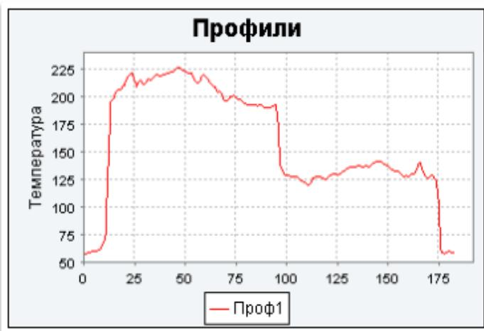
Нагревательный элемент бытовой электроплитки был покрыт слоем теплоизолятора БРОНЯ толщиной 2 мм. Температура поверхности нагревательного элемента, не покрытой теплоизоляционным покрытием, составляет в среднем по области 210 град С, максимальная - около 225 град С. Температура поверхности нагревательного элемента, покрытой теплоизоляционным покрытием, составляет в среднем по области 133 град С, максимальная - около 135 град С.
