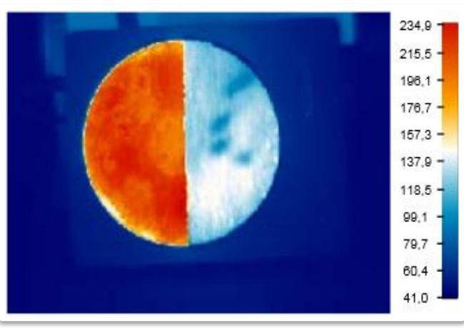
На термограмме видны следы прикосновения в течение 20 секунд.
